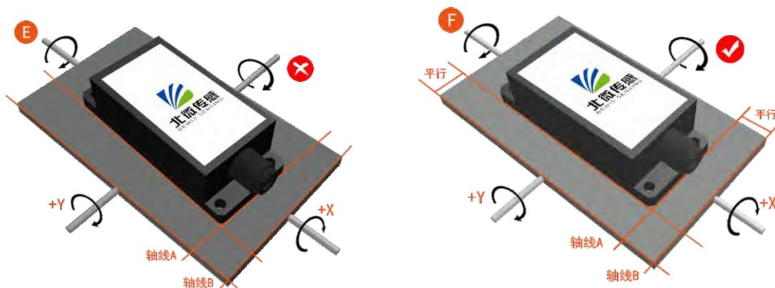
最后，传感器的安装面与被测量面必须固定紧密、接触平整、转动稳定，要避免由于加速度、振动产生的测量误差。
