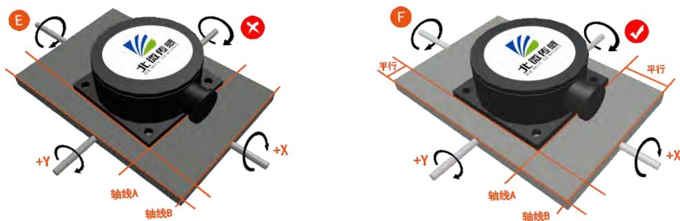
最后，传感器的安装面与被测量面必须固定紧密、接触平整、转动稳定，要避免由于加速度、振动产生的测量误差。
