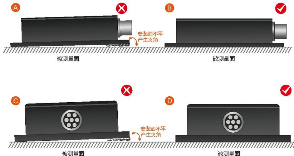
其次，传感器底边线和被测物体轴线不能有如图 E 图所示的夹角产生，安装时应保持传感器底边线与被测物体转动轴线平行或正交。本产品可水平安装也可垂直安装（垂直安装需要定制），正确安装方式如图 F 所示。
